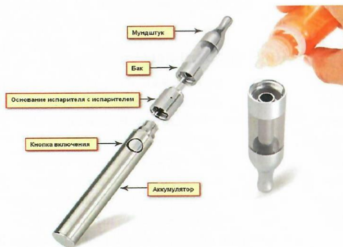
Рис. 3. Устройство электронной сигареты
